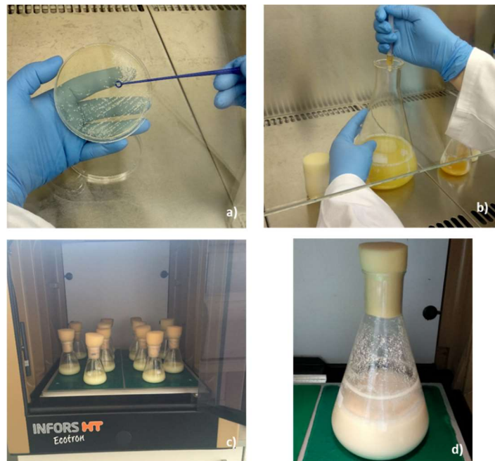
Figura 3.4. Proceso de producción de etanol mediante fermentación de suero lácteo utilizando la levadura Kluyveromyces marxianus . a) Placa de cultivo puro de klumveromyces marxianus ; b) Proceso de inoculación del microorganismo en el medio de fermentación; c) Fermentación de las muestras en el incubador con agitación orbital; d) Aspecto de la muestra tras finalizar la fermentación alcohólica.
