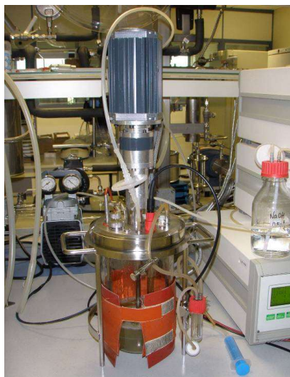
Figura 3.6. Biorreactor Biostat B ® de 2 L (Sartorius, Alemania) con Micro-DCU (Braun, Alemania).
