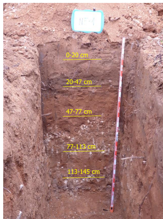
Figura II.4. Calicata realizada en el ensayo experimental para el estudio del suelo.
